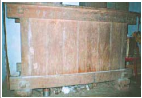
သစ်သားပုတ် - အမြင့် = ၁.၅ မီတာ၊ အကျယ် = ၂ မီတာ၊ ဝင်ဆန့်မှု = ၅၀၀ ကီလိုဂရမ်ကျော်
