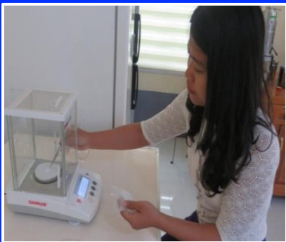
ဆန်မှုန့် (0.1g) အား analytical balance ဖြင့် ချိန်ပြီး test tube ထဲ ထည့်ခြင်း
